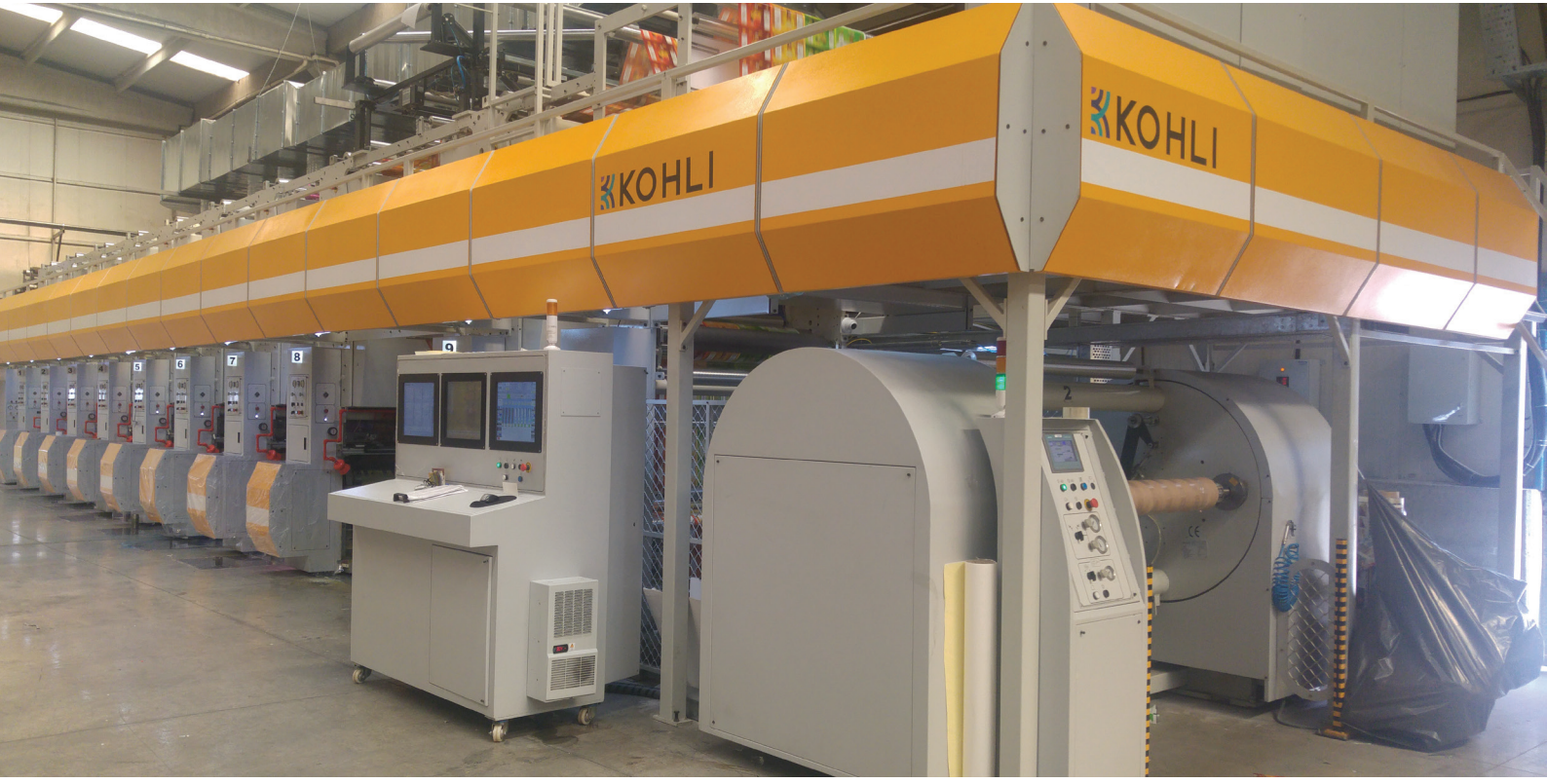
9 Renk Rotogravür Baskı Makinesi 9 Colors Rotogravure Printing Machine
