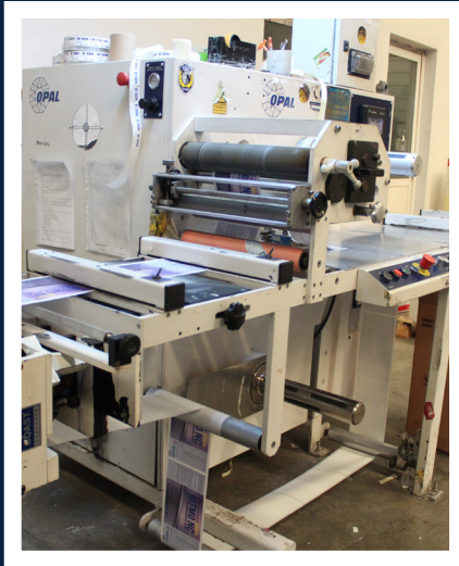
Kalite Kontrol Dilimleme Makinesi No: 2 Inspection Slitting Machine Number: 2
