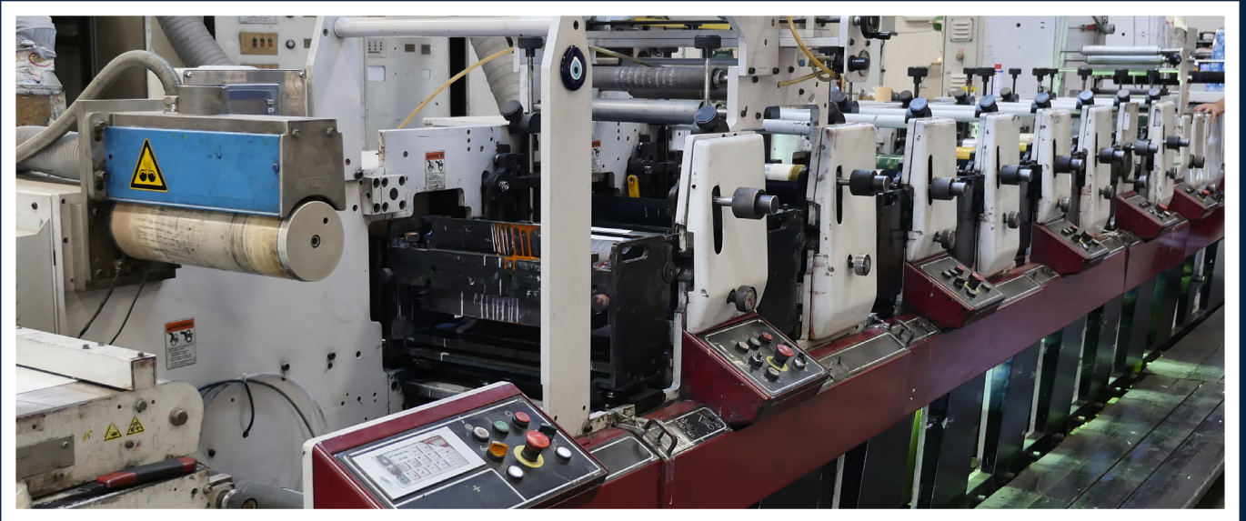
8 Renk UV Flekso Baskı Makinesi 8 Color UV Flexo Printing Machine
